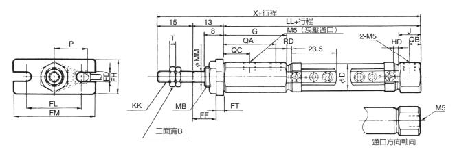
●注1:  $\phi$  6、  $\phi$  10的通口螺絲深度為3.8mm,因此如須使用接頭,請使用螺絲部長度3.8mm以下的接頭。
