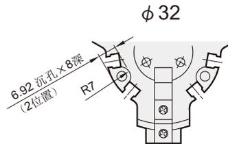
注意：不同的沉孔配置只針對傳感器固定溝槽間的安裝孔。
